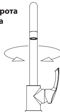
Аэратор (регулятор расхода воды) позволяет смесителю «выдавать» ровную водную струю без разбрызгивания.
