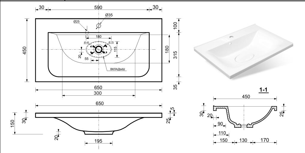
ПРОИЗВОДСТВО ИЗДЕЛИЙ ИЗ ЛИТЬЕВОГО МРАМОРА \*Допустимое отклонение линейных размеров ± 5мм
