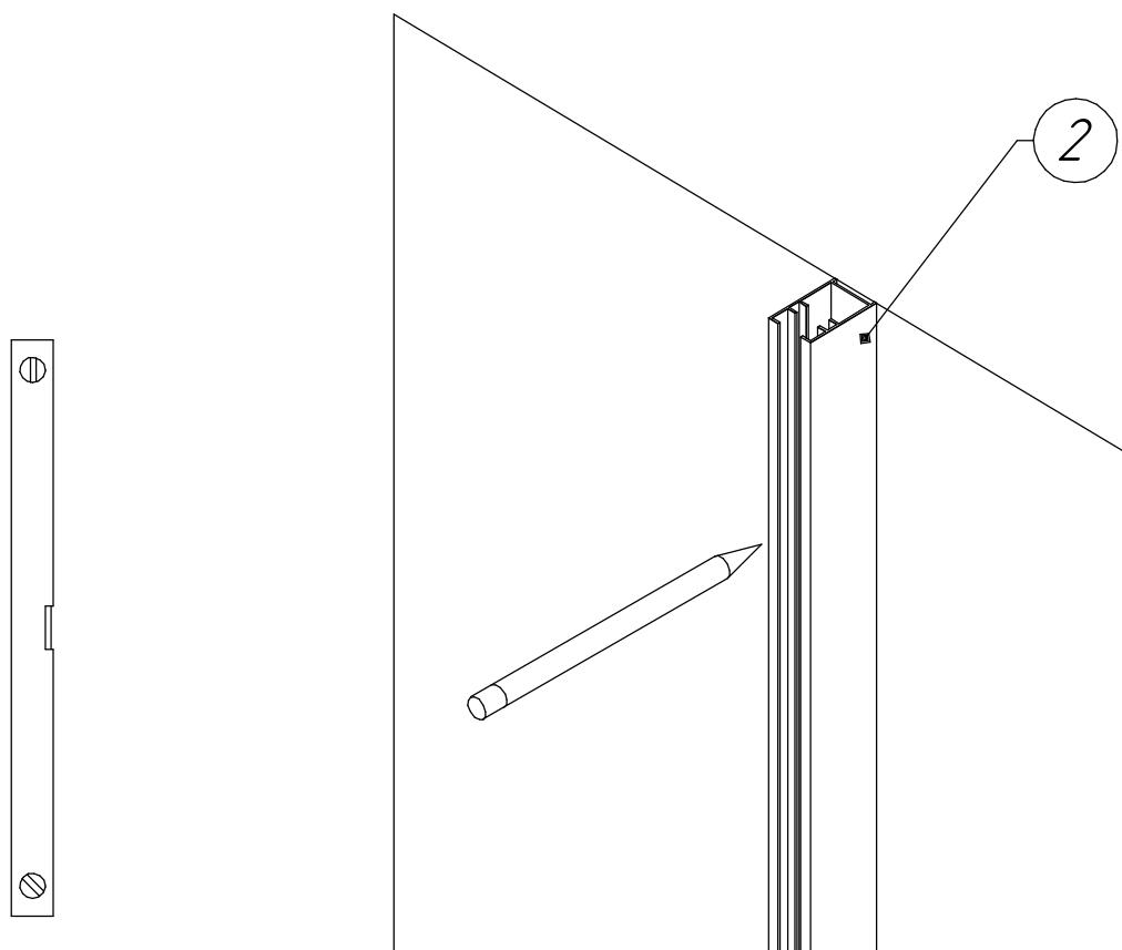
**3.** В месте установки стекла снизу наклейте прозрачную монтажную ленту для того, чтобы не повредить стекло при установке и создать отверстие для герметика.
