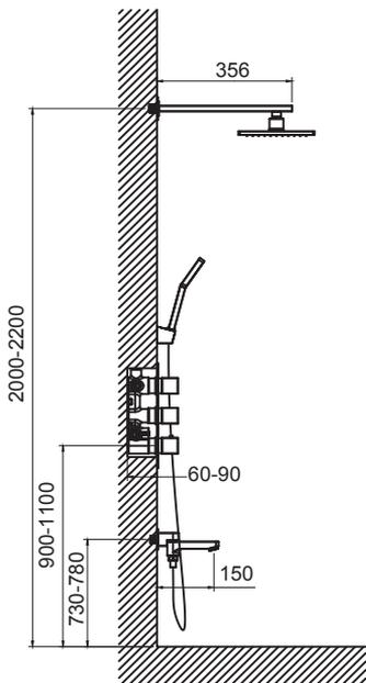
Определите точное место установки смесителя. Рекомендуем устанавливать смеситель на высоту 900-1100 мм от уровня пола. Подведите водопроводные трубы так, чтобы монтаж и демонтаж смесителя не вызывал затруднений. Убедитесь, что подача горячей воды слева, а холодной справа. Промойте впускные трубы перед финишной установкой.
