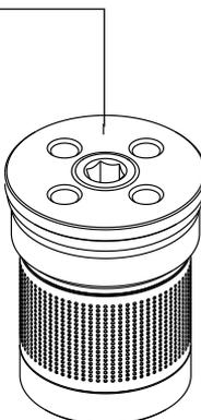
Внимание: обратный клапан отрегулирован на фабрике и открыт на максимальный поток воды.
